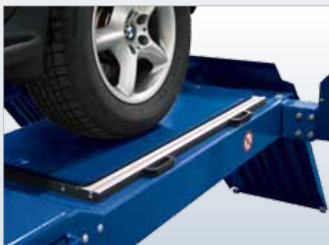
Präzisions-Schiebeplatte (Option, nur für „W“-Ausführung); Minimales Losbrechmoment 5 Nm und minimale Verschiebekraft 15 N bei 500 kg Radlast, große Menge an Stahlkugeln, gehärtete Lauffläche, Auffangrillen für Schmutzwasser.
