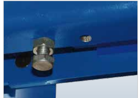
Quertraversen im abgelassenen Zustand über Absetzschrauben zur Grundplatte justierbar.
