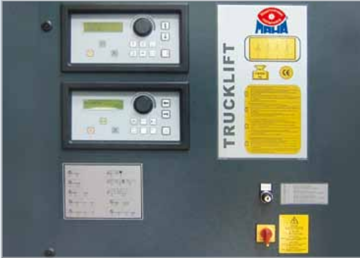
Zentrale Steuer- und Programmierereinheit mit zwei Displays.
