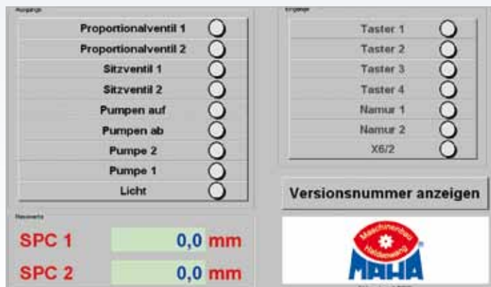
Integrierte PC-Schnittstelle zur Fehlerauslese, auch über Ferndiagnose durchführbar.
