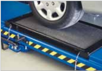
Schiebeplatte mit möglicher Drehbewegung +/- 5° und einer Seitenbewegung von +/- 50 mm.
