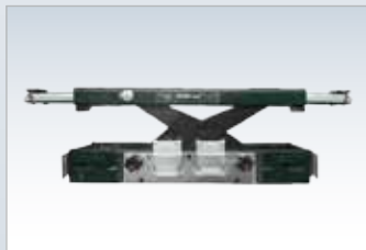
Mit dem Achslift AL II 2.0 / 2.6 ist durch die große Auszugslänge zur Achsvermessung ein Anheben der Achse an den Federbeinen möglich, ohne Einfedern der Räder.
