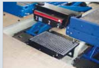
Pneumatischer Hubboden bei definierter Achsliftposition für Streifenfundament (DUO 3.5 / DUO GN).
