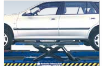
Radfreiheber zum Anheben des gesamten Fahrzeuges auf der Bühne.
