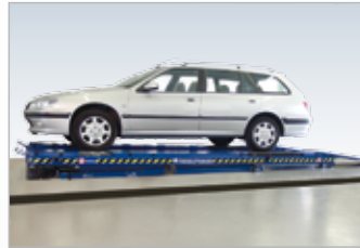
Schrägstellung bei Überflurmontage, hydraulisch oder mechanisch, zur leichteren Auf- und Abfahrt.
