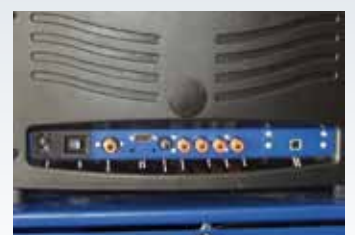
MGT 5 ASM Rückseite: 2 Punkt Kalibrierung (High-, Low-, und Null-Gas).
