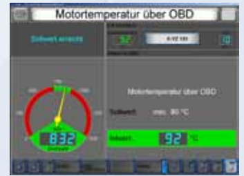
Drehzahl, Motortemperatur über OBD.
