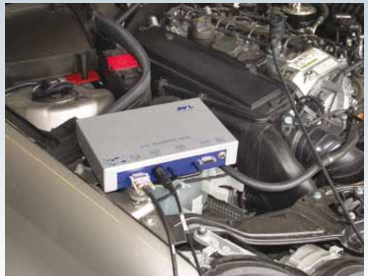
DISPEED 492, praxisingerechte Drehzahlmessung über Magnet-Kombisensor.
