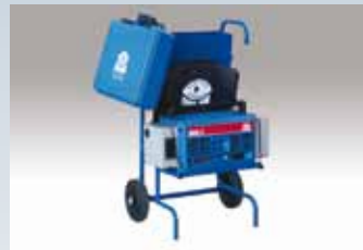
Gerätewagen und Transportkoffer für Messzelle im mobilen Einsatz.
