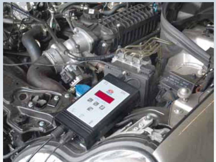
RPM VC 2, Drehzahlmessung über Vibrationssensor oder Oberwelligkeit der Bordspannung.
