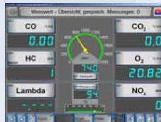
Messwertübersicht. Funktionelle Darstellung aller Messwerte (hier mit Drehzahl- und Öltemperaturfunktion / NOx-Messung optional möglich).
