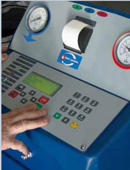
Großes beleuchtetes Gerätedisplay mit Schnellauswahlmenü und integriertem Drucker (MAC 2000P)
