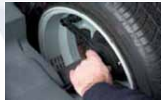
Automatische Blockierung in der Ausgleichsposition des Rades und der Messlehre.
