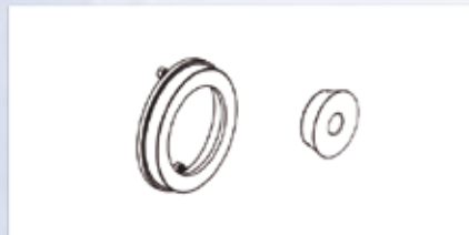
Distanzstück WD für Räder mit tiefem Radsturz und Geländewagen. Konus J für Geländewagenräder mit einem Loch von Ø 101 bis 119 mm.
